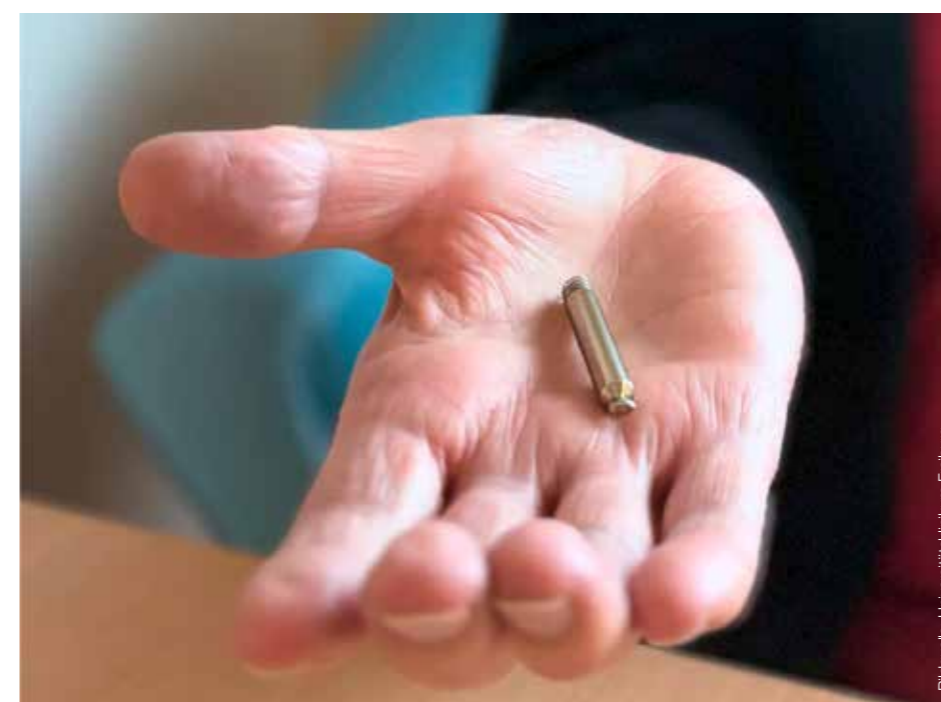
Abb. 1: Mit einer Größe von nur 1,5 Zentimetern kann der neuentwickelte elektrodenlose Herzschrittmacher direkt in die rechte Hauptkammer des Herzens eingesetzt werden.
