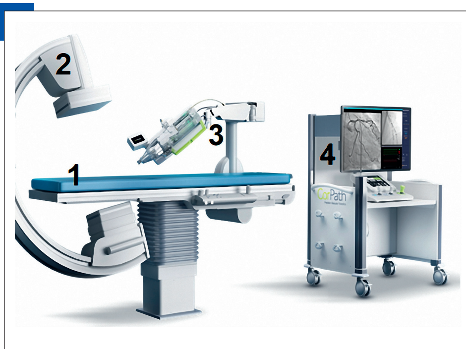
Abb. 1: Aufbau der Herzkatheteranlage mit Robotik (Corindus CorPath GRX, Siemens) Die konventionelle Herzkatheteranlage bestehend aus Patiententisch (1) und Röntgenanlage (2) wird ergänzt durch den Roboterarm (3). Dieser wird während der Herzkatheteruntersuchung von dem*der behandelnden Ärzt*in über eine Steuerkonsole (4) aus dem Kontrollraum heraus betätigt.
