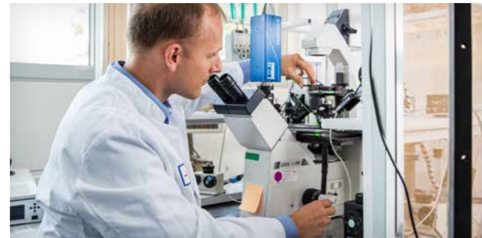
Abb. 2: Moderne Patch-Clamp Geräte erfordern Kenntnis sowohl der Biologie von zu untersuchenden Zellen, als auch der biophysikalischen Grundlagen der Messtechnik. Oft (und auch hier) werden diese zudem mit weiteren mikro-mechanischen und optischen Verfahren kombiniert.
